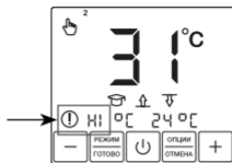
Рис. 18. Замыкание датчика обогрева
