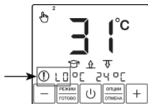
Рис. 17. Обрыв датчика обогрева
