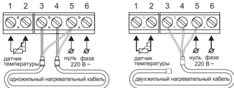
Рис. 4. Схема подключения к 2-х проводной сети питания нагревательных секций и матов
