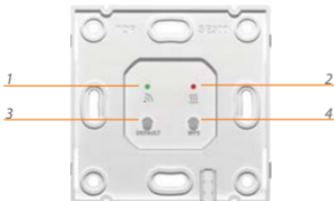
Рис. 2. Терморегулятор MCS 300 со снятой лицевой крышкой.
