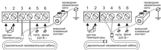
Рис. 5. Схема подключения к 3-х проводной сети питания нагревательных секций и матов
