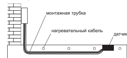
Рисунок 2. Способ монтажа датчика осадков при подогреве грунта.
