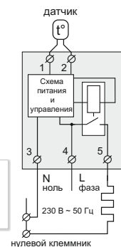
Схема 1. Упрощенная внутренняя схема и схема подключения
