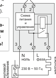
Схема 1. Упрощенная внутренняя схема и схема подключения
